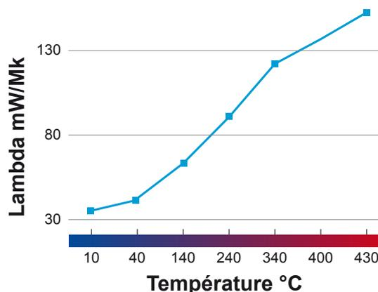
Le coefficient de conductivité thermique « Lambda » est issu des données du fabricant.
